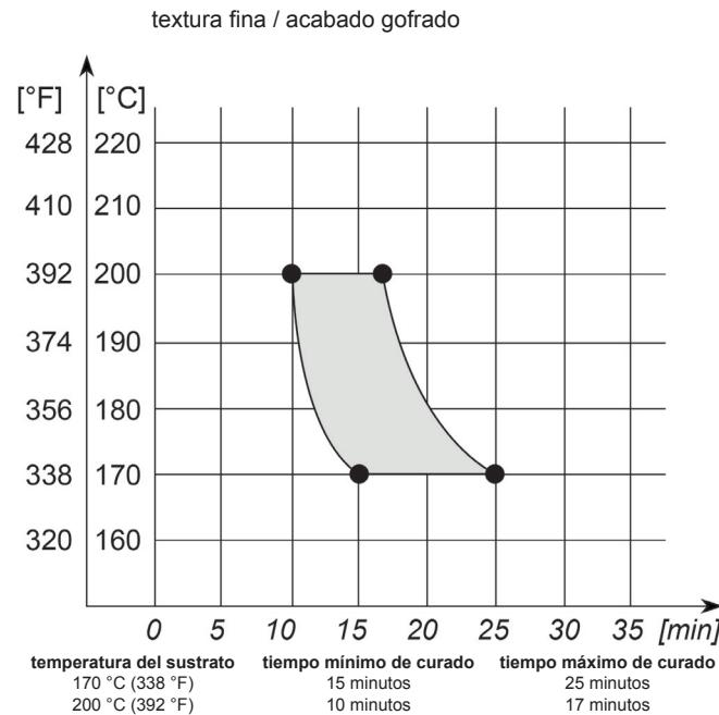
Los parámetros de curado deben ser seguidos adecuadamente debido a que las propiedades mecánicas se desarrollan antes de la polimerización (reticulación) completa.
